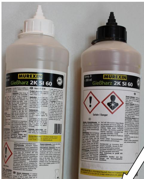
Die Komponente B (Härter) ist vollständig in die Flasche Komponente A zu gießen. Die zusammengekippten Komponenten sind mind. 20 Sekunden lang gut durchzuschütteln. Nach einer Wartezeit von ca. 2,5 Minuten ist die Mischung aus der Flasche A in das obere Loch der Tragösenkappe einzufüllen. Das eingefüllte Gießharz ist nach etwa 30 Minuten ausgehärtet.
